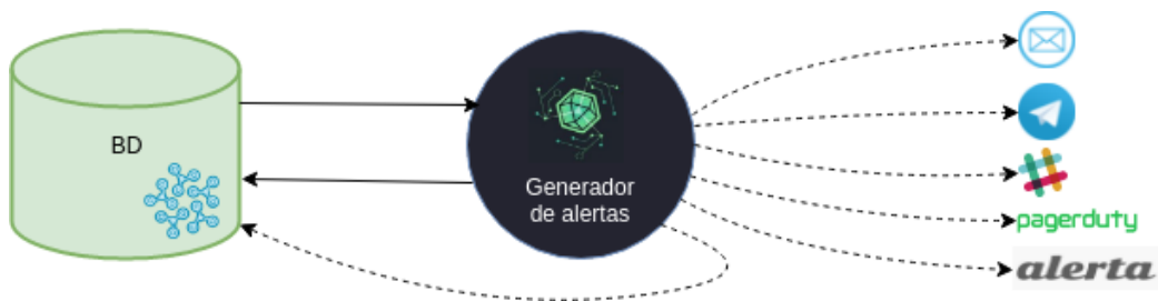
Figura 17: Kapacitor genera alertas a diferentes destinos a partir de información tomada de InfluxDB
